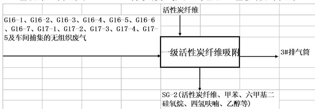
图 3.4-5 加氢车间废气处理工艺流程
