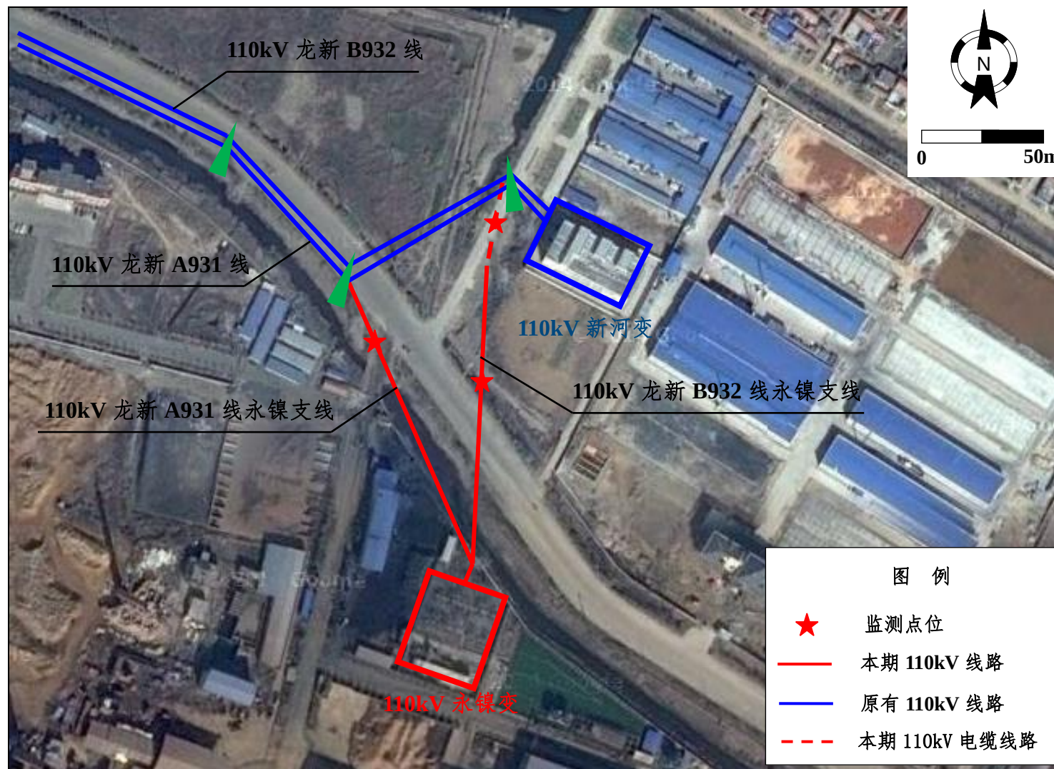
附图 5 110kV 永镍变配套线路路径示意图
