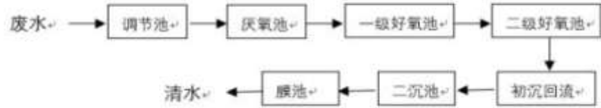
图 4.2-2 南辰社区污水处理设施工艺流程图
