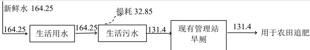
图 4-3 项目水平衡图 (t/a)
