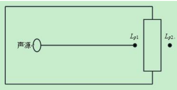
图 4-2 室内声源等效为室外声源图例
