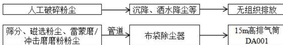
图4-1 本项目废气处理工艺流程
