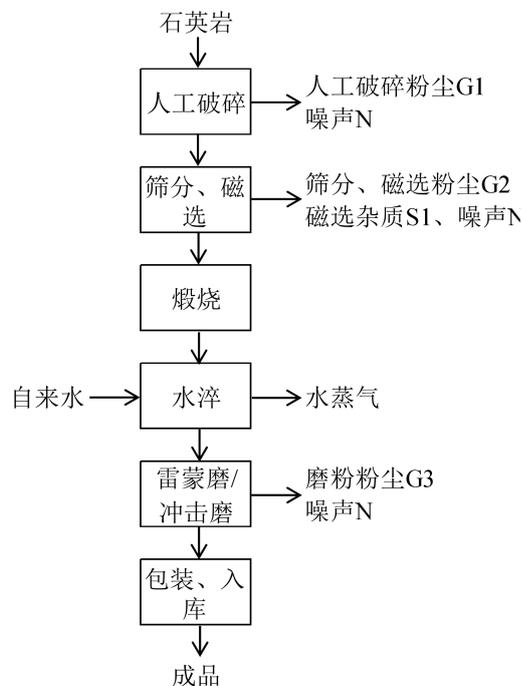
图 2-2 高纯石英砂生产线生产工艺流程图
