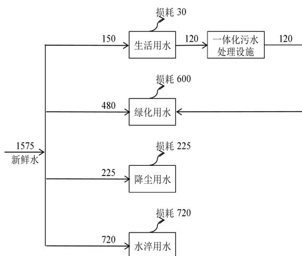
图 2-1 本项目水平衡图（单位：t/a）
