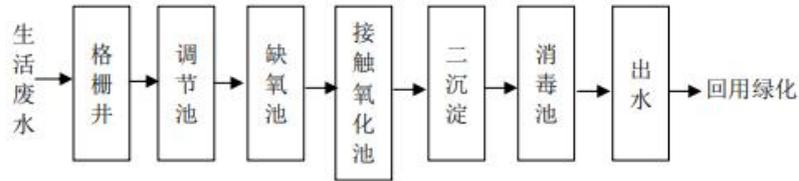
图 4-3 污水处理装置工艺流程图
