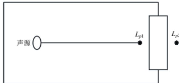
图 4-2 室内声源等效为室外声源图例
