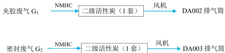
图 4-1 本项目废气收集及治理流程图
