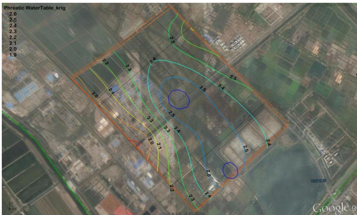
图5.1-5 潜水位等值线图
