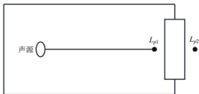
图 4-5 室内声源等效为室外声源图例
