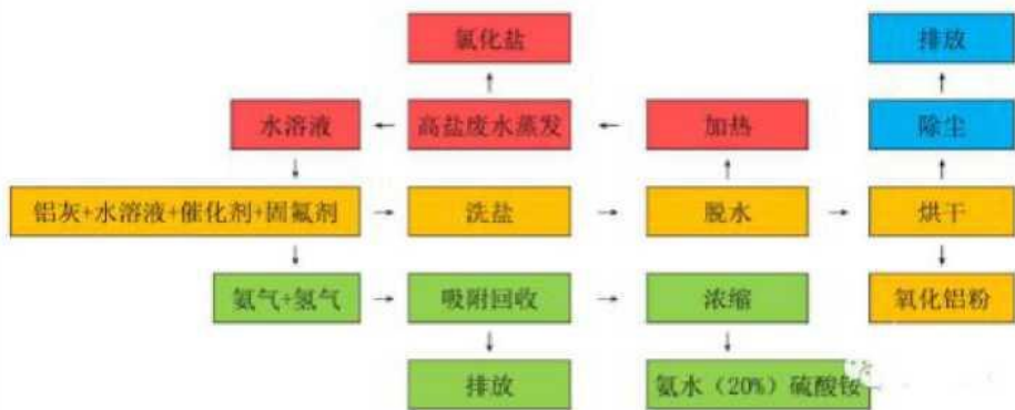
图3.3.2-1 铝灰无害化处理工艺
