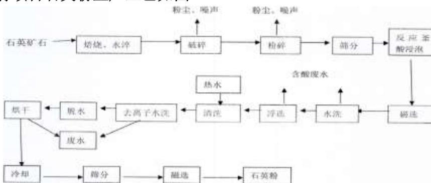
图 2-8 原有项目石英粉工艺流程图
