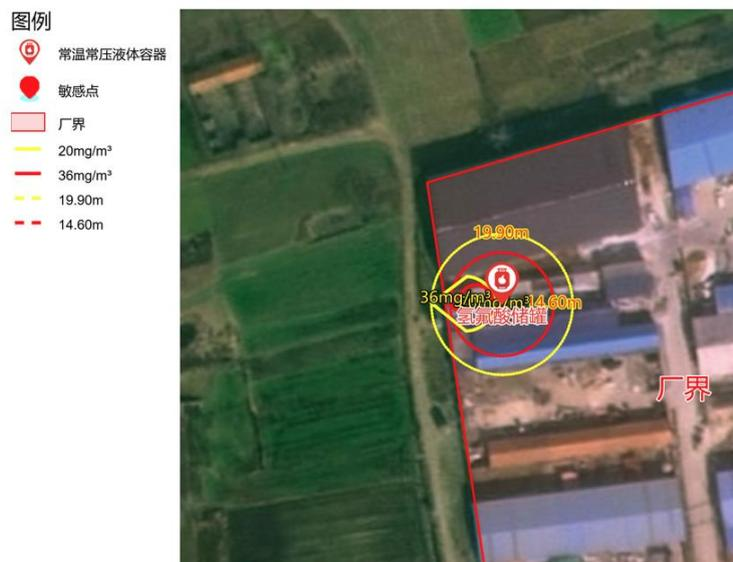
图 5.1-2 氢氟酸储罐泄漏影响范围图
