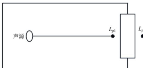
图 5.3-1 室内声源等效为室外声源图例
