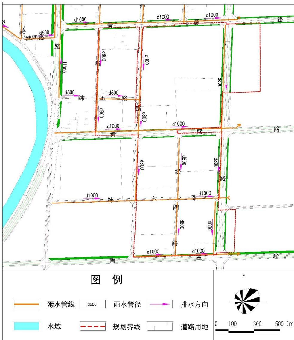
图 2.6-3 青湖镇工业集中区雨水工程规划图
