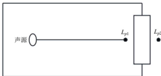
图 5.3-1 室内声源等效为室外声源图例
