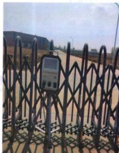
附图 2: 厂界下风向废气采样现场
