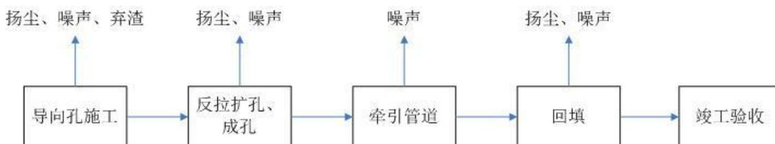
图 2-4 管道工程拖拉管施工工艺
