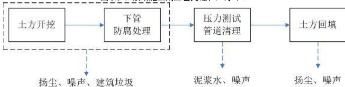
图 3.5-2 输水管道施工期工艺流程和产污环节
