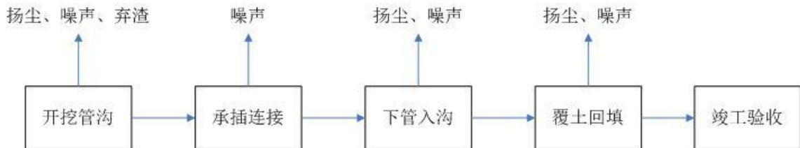
图 2-5 管道工程开槽施工工艺
