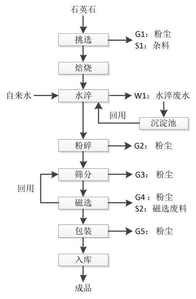
图 2-2 高纯石英砂生产工艺及产污流程图
