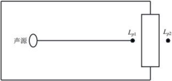
图 4-5 室内声源等效为室外声源图例
