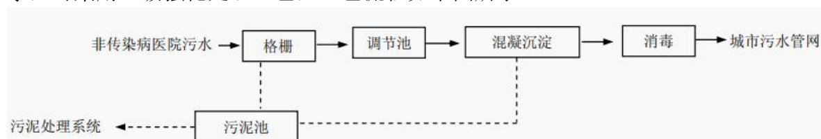
图 4-3 非传染病医院污水一级强化处理工艺流程
