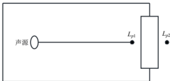
图 4-1 室内声源等效为室外声源图例
