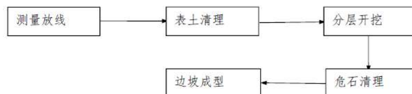
图 2-2 削（清）坡工程流程图
