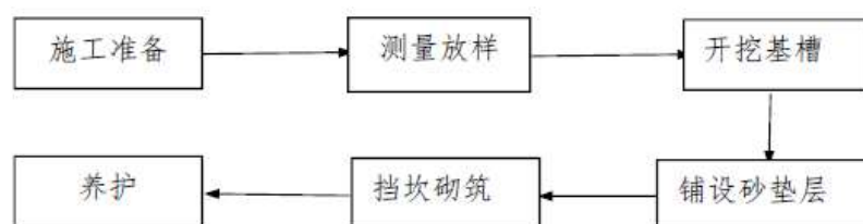
图 2-6 浆砌石技术工艺流程图
