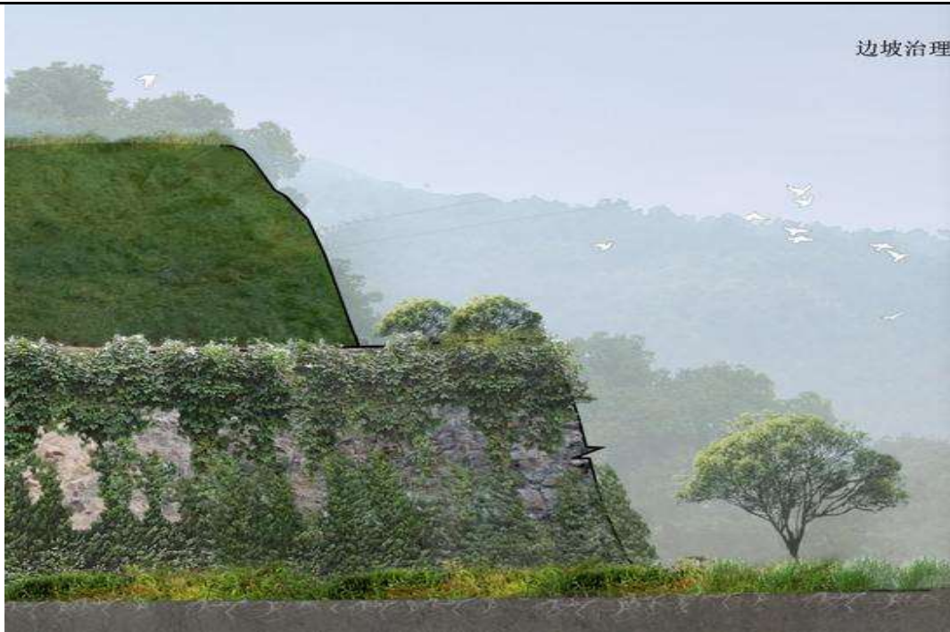
图 2-12 边坡挂网喷播及种植爬藤效果示意图
