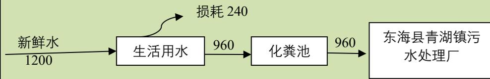
图 2-1 本项目水平衡图
