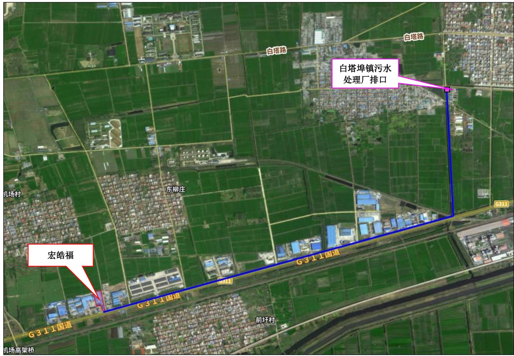
图 10 本项目接管至白塔埠镇污水处理厂尾水排放口处的排放通道线路图
