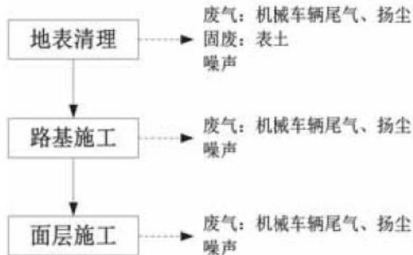
图2-4 进场道路施工工艺流程图
