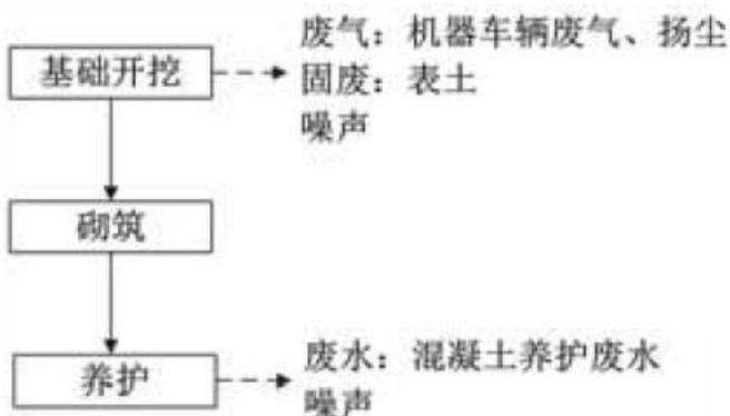
图2-6 沉淀池施工工艺流程图
