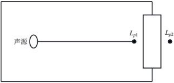
图 4-2 室内声源等效为室外声源图例
