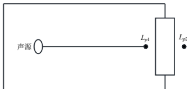
图 4-6 室内声源等效为室外声源图例
