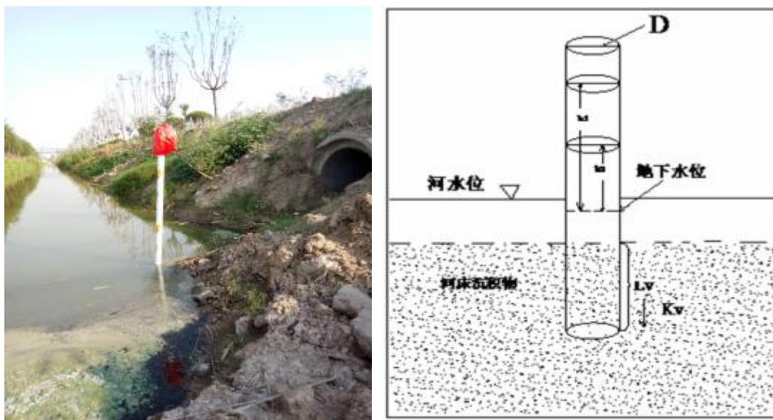
图 5.3-1 竖管试验现场及示意图
