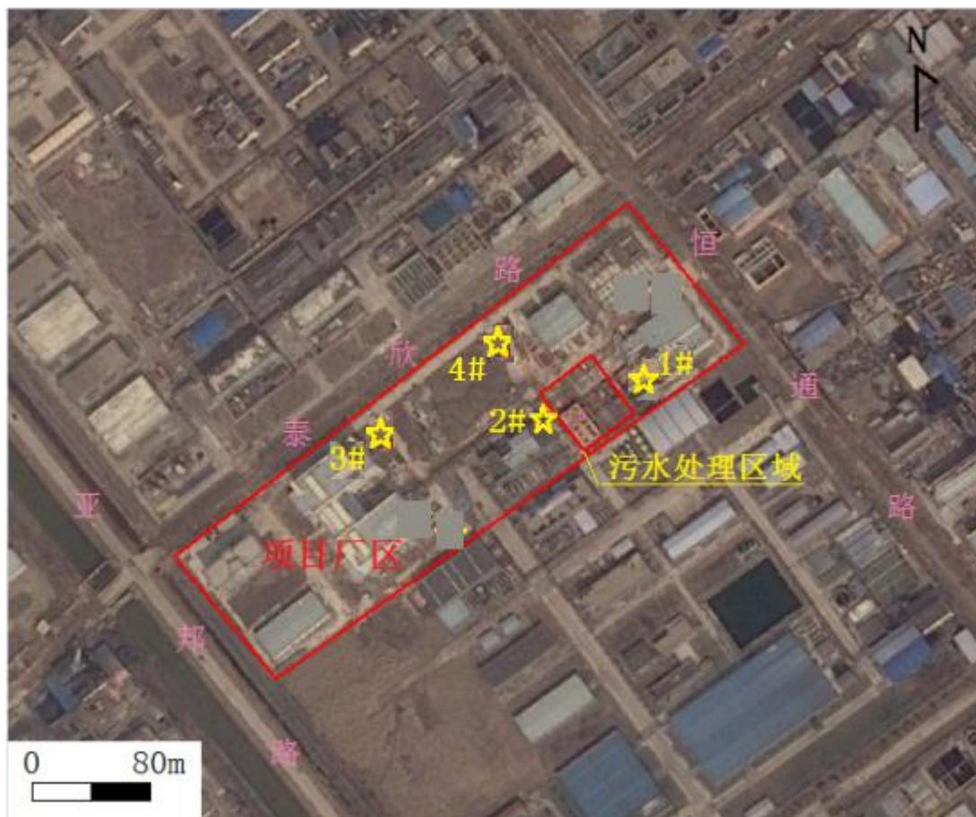
图 6.2 项目地地下水跟踪监测孔布置图
