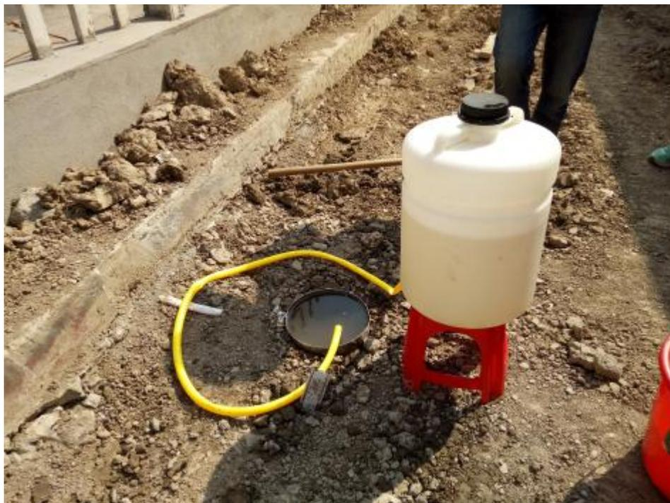
图 5.3-2 现场单环实验照片
