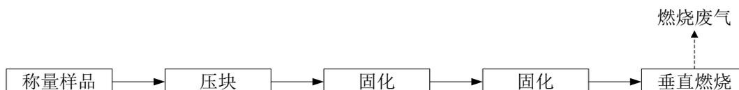
图 5-3 产品燃烧性能测试工艺流程及产污环节
