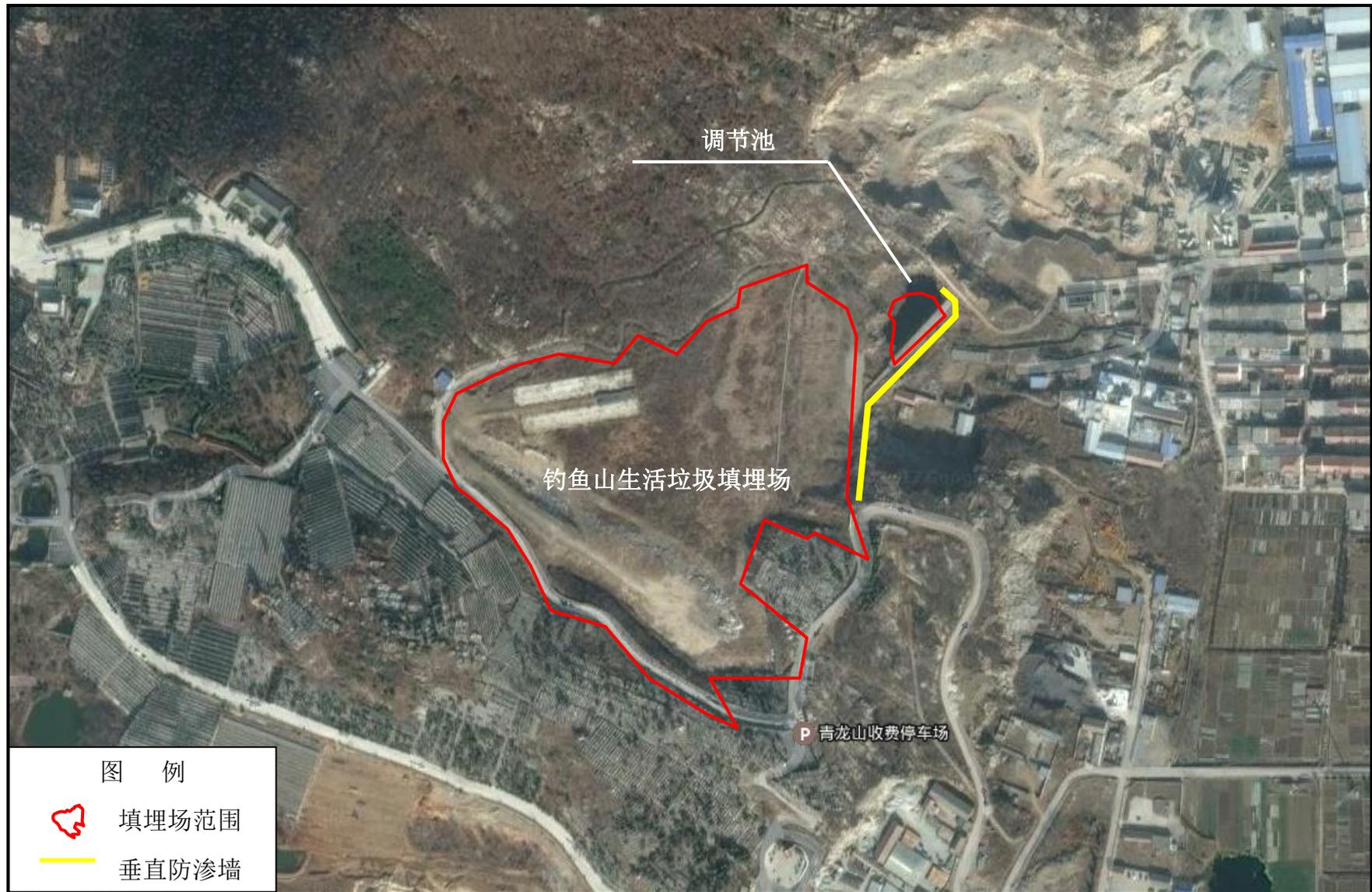
图 7.5-1 填埋场垂直防渗墙位置示意图
