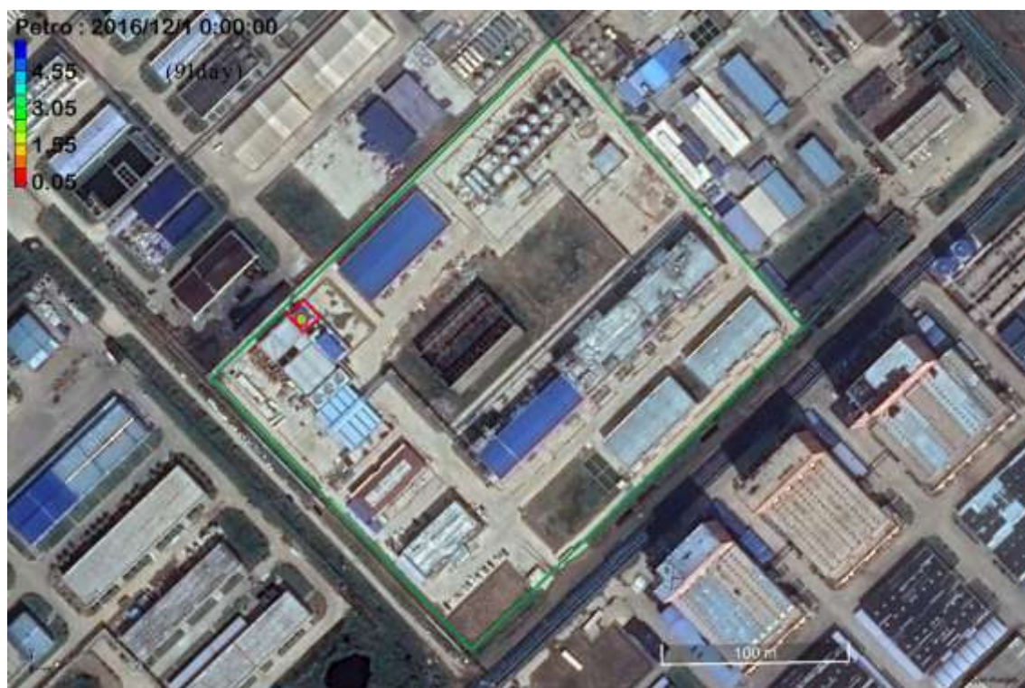
图 4.2-9 非正常工况石油类渗漏一年含水层影响范围 (91day, 3 个月)
