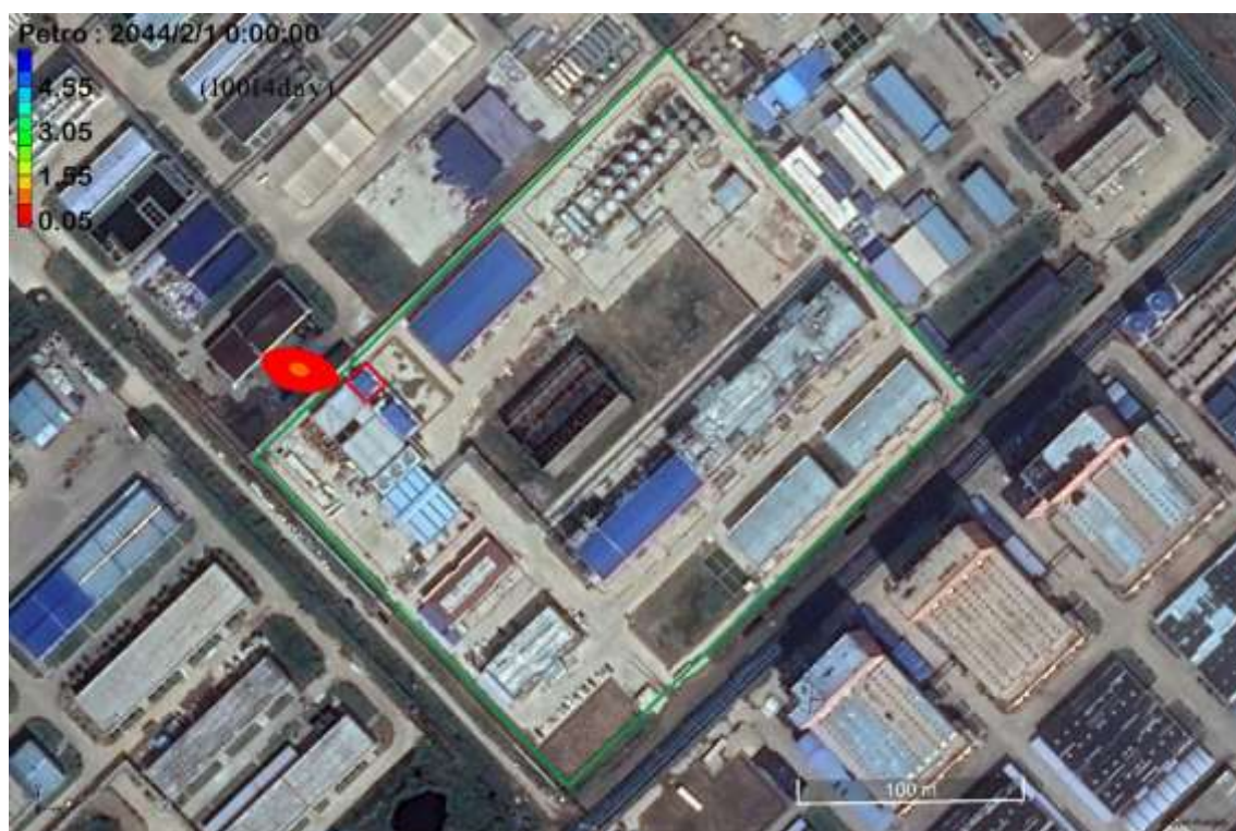
图 4.2-12 非正常工况石油类渗漏一年含水层影响范围（10014day，329 个月）
