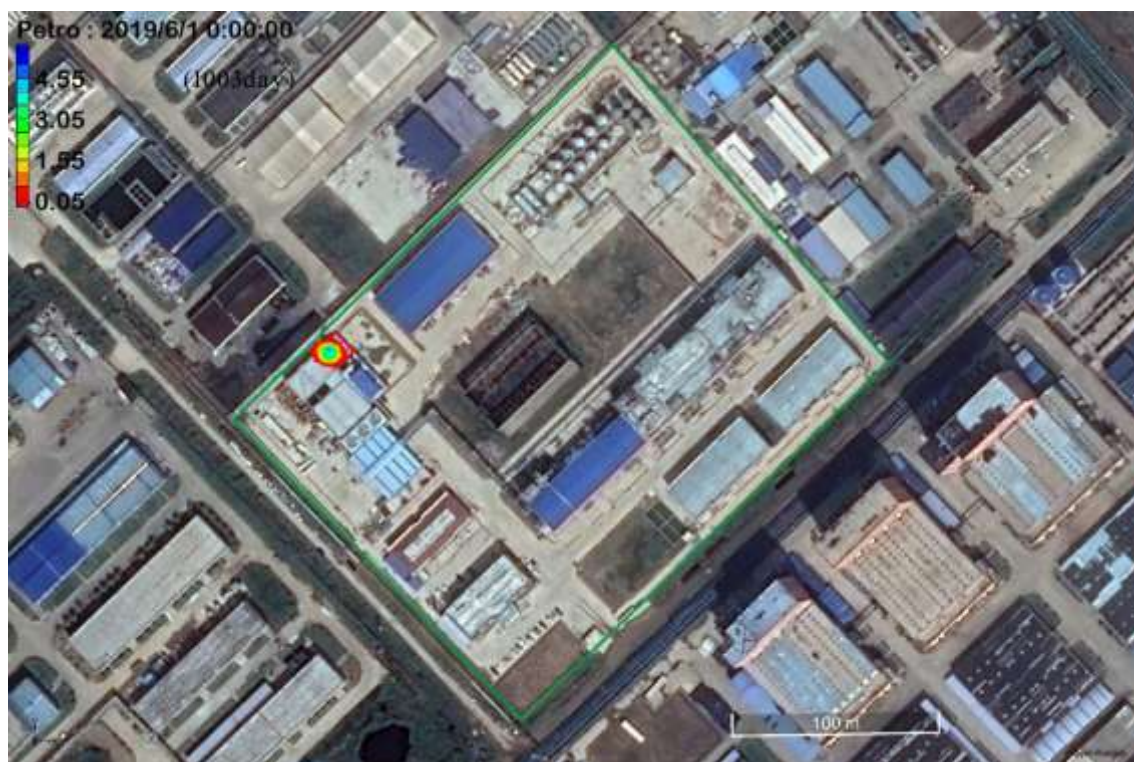
图 4.2-11 非正常工况石油类渗漏一年含水层影响范围（1003day，33 个月）
