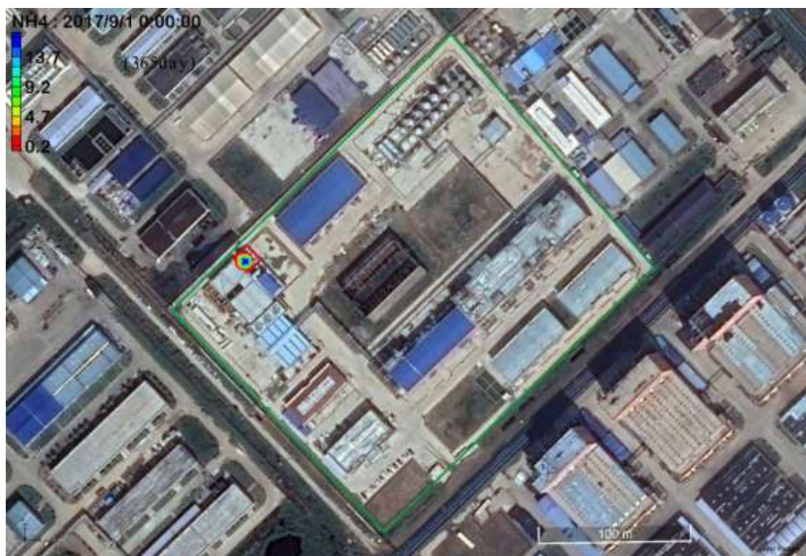
图 4.2-6 非正常工况氨氮渗漏一年含水层影响范围 (365day, 12 个月)
