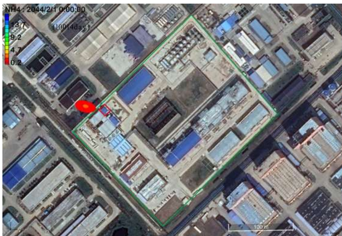
图 4.2-8 非正常工况氨氮渗漏一年含水层影响范围 (10014day, 329 个月)
