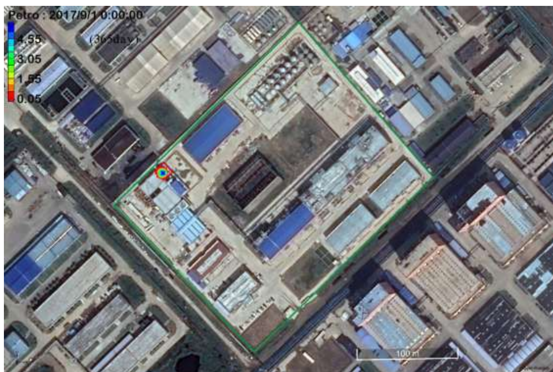
图 4.2-10 非正常工况石油类渗漏一年含水层影响范围 (365day, 12 个月)
