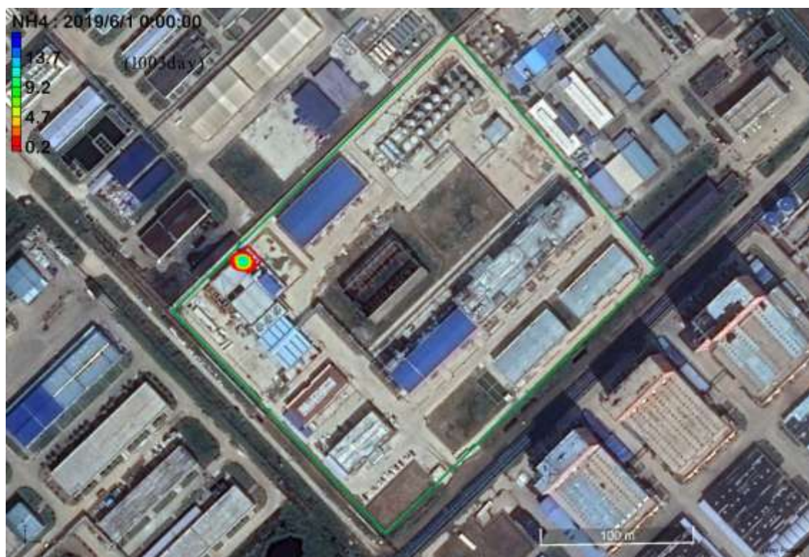
图 4.2-7 非正常工况氨氮渗漏一年含水层影响范围 (1003day, 33 个月)
