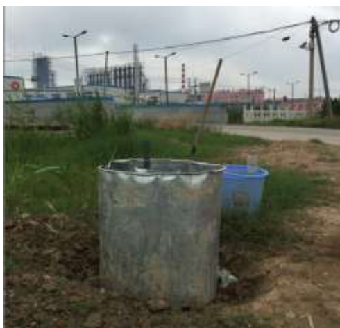
照片 3.3-1 野外双环入渗试验
