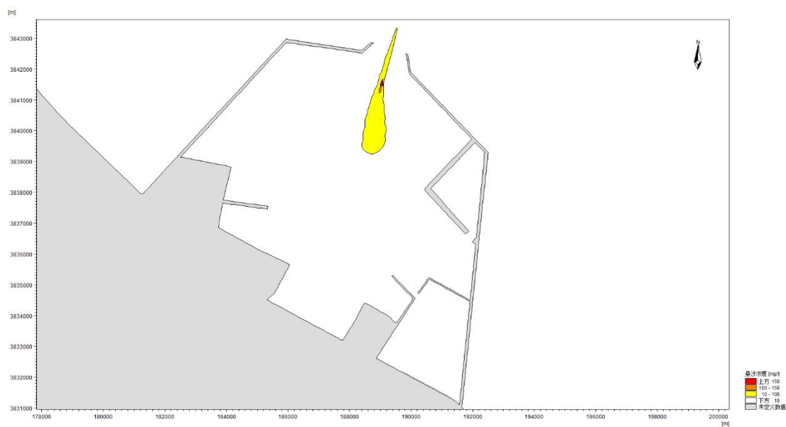
图 6.3-2 港池疏浚施工代表点 2 悬浮物最大可能影响范围
