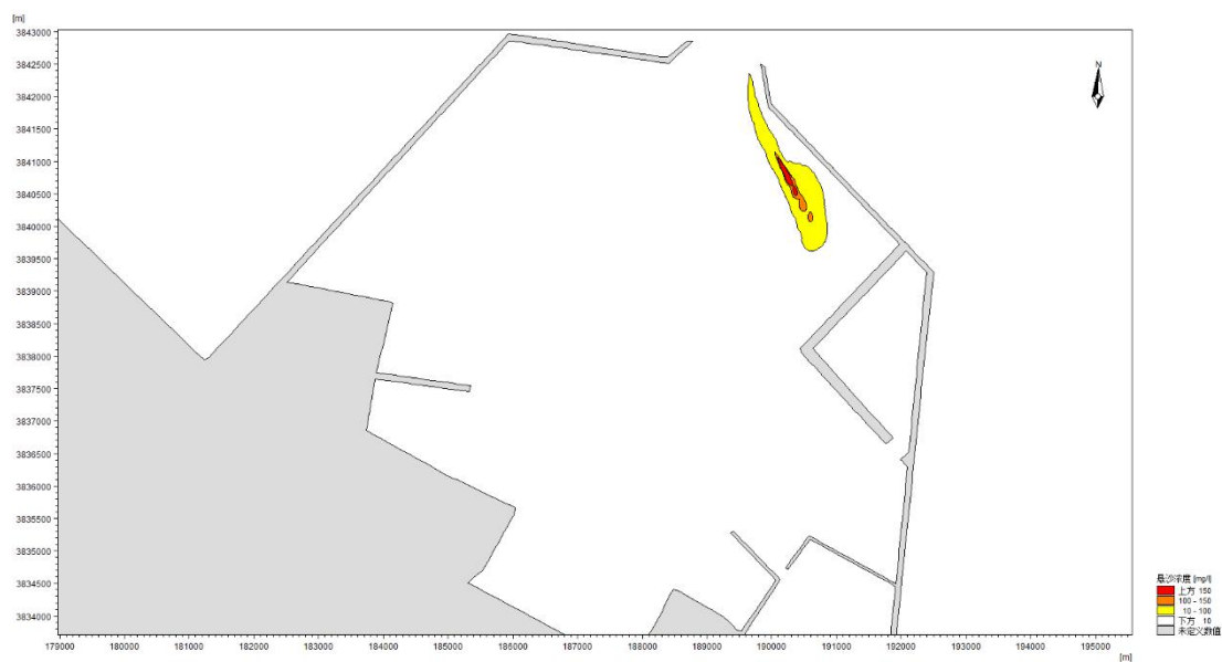
图 6.3-3 港池疏浚施工代表点 3 悬浮物最大可能影响范围
