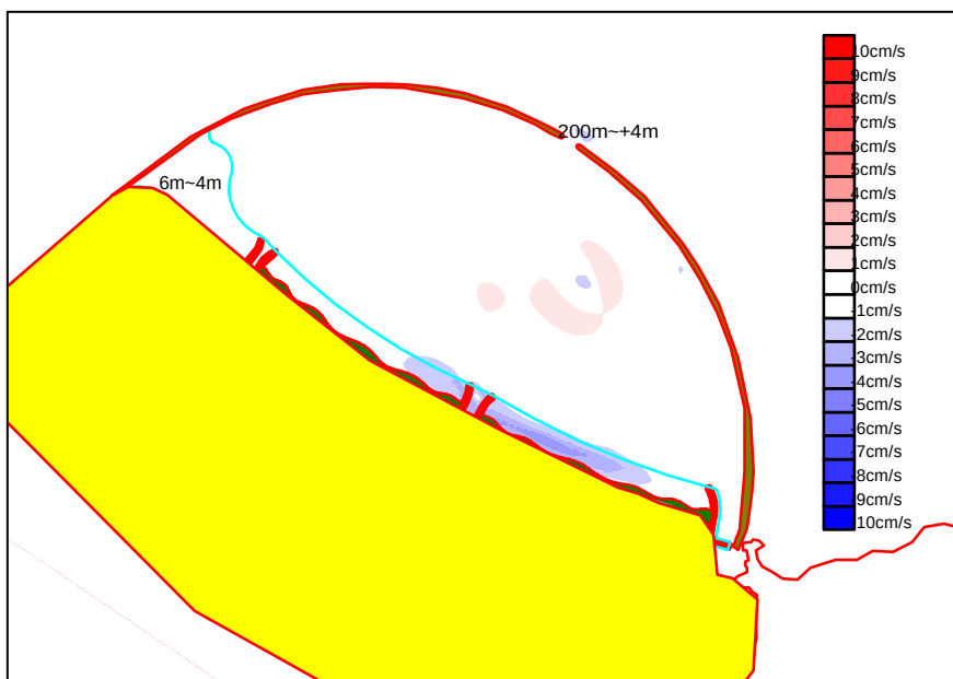
图 6.1-9 (b) 工程后建设后落潮平均流速变化等值线图
